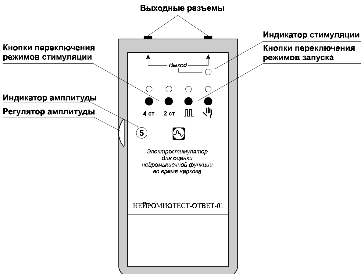
Рисунок 5 - Внешний вид электростимулятора “Нейромиотест-ответ - 01”.
